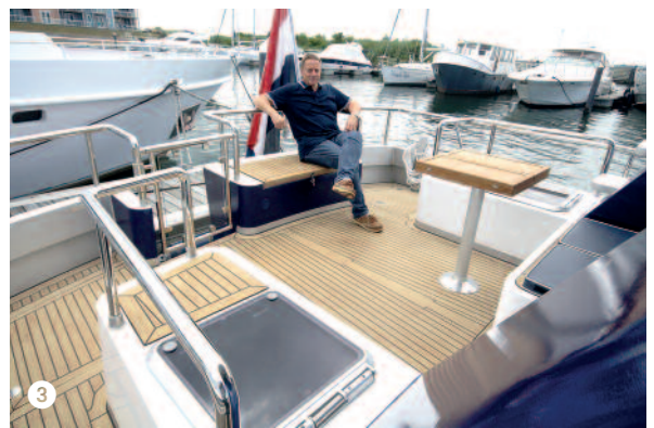
3 Großzügig dimensioniert das achterliche Cockpit mit den Aufbau-Glasluken für viel Tageslicht unter Deck. Besonders stabil die VA-Relingsaufbauten.
